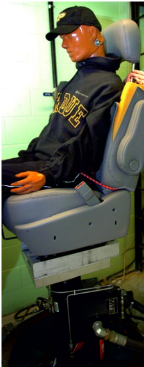
Rys. 1. Układ biomechaniczny siedzenia samochodowego o dwóch stopniach swobody.
